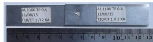
**Gambar 2.** Spesimen yang telah dilas
